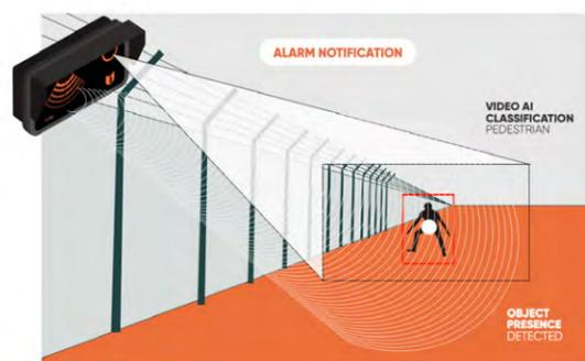
**v-FOX A0RS** permette di effettuare installazioni di sicurezza automatiche ed estremamente affidabili, riducendo drasticamente il fenomeno dei falsi allarmi e tutelando l'installazione da tentativi di intrusione con camuffamenti operati con qualsiasi tipologia di materiale.
