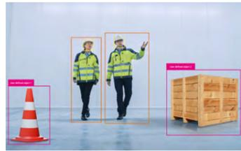
**WiseDetector**, una funzionalità basata sul machine learning che "istruisce" le telecamere a rilevare nuove tipologie di oggetti sulla base di un modello definito dall'utente, è supportata nelle telecamere **Hanwha serie P** con intelligenza artificiale a bordo e non richiede licenze.
