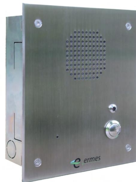
La scatola da incasso è realizzata in acciaio con spessore 15/10 ed ha delle alette antistrappo che ne impediscono la rimozione dal muro; il pannello frontale è in acciaio inox con spessore di 30/10 ed è fissato con viti anti-manomissione monouso con testa che permette il solo avvitarlo.
