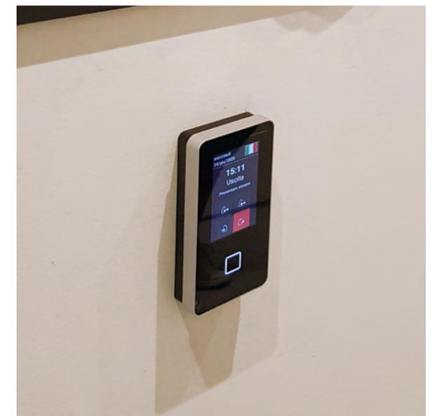
I terminali si interfacciano con il software di controllo accessi e rilevazione presenze del partner Vulcano, in una versione personalizzata sulla base di specifiche del cliente. Oltre alla rilevazione delle presenze, sono stati aggiunti altri moduli quali la gestione della **formazione** e delle **visite mediche**, nonché la versione web per la **gestione preventivata delle assenze**.
