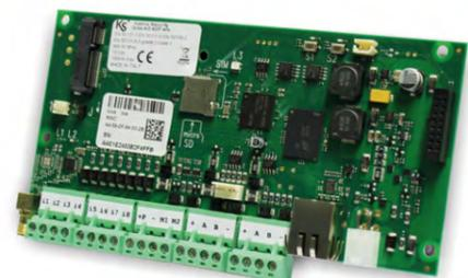
**Scheda lares 4.0 / 40-IP ibrida:** gestisce no a 40 IN + 40 OUT con 12 partizioni - nativa con interfaccia Ethernet. (senza wireless a bordo - necessita ricetrasmittitore duo) Include le APP Installatore (Ksenia Pro) e Utente (lares 4.0). Conforme EN 50131-GRADO 3.
