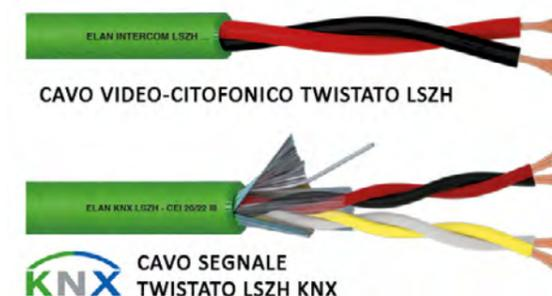
coppia twistata da 1.00mm<sup>2</sup> a bassissima capacità. Grazie ad uno speciale isolamento a base PPE in LSZH, ELAN è riuscita ad arrivare ad una capacità inferiore a 50 pF/mt. Questo prodotto va a completare, dunque, la gamma ELAN che vede costantemente nascere nuovi prodotti avanzati capaci di stare al passo con le nuove tecnologie e applicazioni.
