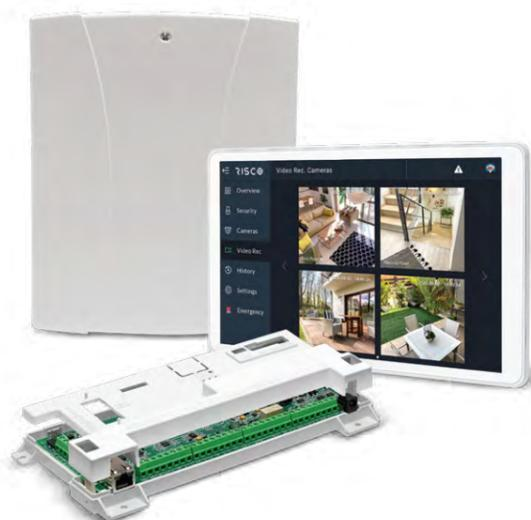
I **moduli di comunicazione IP e Wi-Fi** sono già integrati nella centrale, per assicurare una connessione sempre disponibile a **RISCO Cloud**, anche per eventuali necessità di configurazione remota. Un modulo di comunicazione opzionale GSM 4G è altresì disponibile, sia come canale di comunicazione primario sia in backup agli altri canali a bordo, IP e Wi-Fi.
