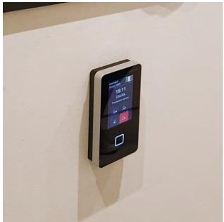
I terminali si interfacciano con il software di controllo accessi e rilevazione presenze del partner Vulcano, in una versione personalizzata sulla base di specifiche del cliente. Oltre alla rilevazione delle presenze, sono stati aggiunti altri moduli quali la gestione della formazione e delle visite mediche, nonché la versione web per la gestione preventivata delle assenze.
